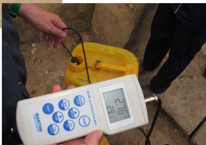
Réservoir de Diarniadio, l'eau vient d'un forage dont l'eau a 3.2 mg de fluor et 2.7 gr de sel par litre. Les standards de l'OMS sont à 1,5 gr de fluor et 0.5 gr de sel par litre.
