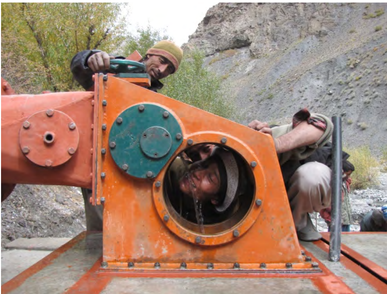
Abbildung 16 Turbine ohne Laufrad
