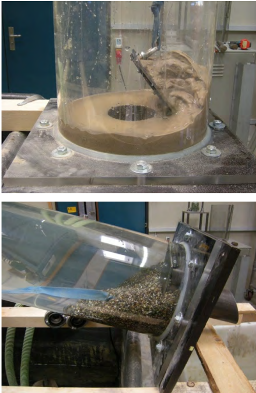
Abbildung 1 Versuchseinrichtung für Spülklappe am Institut Bauingenieurwesen der FHNW
