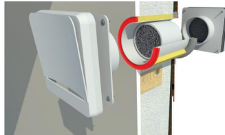
DETALLE 1: DISPOSITIVO DE VENTILACIÓN DE INYECCIÓN PASIVA
