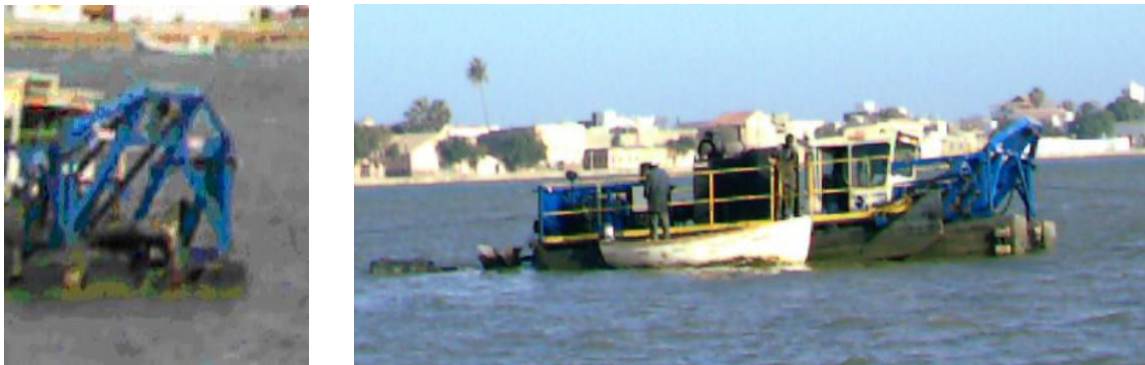
Figure 11 – Faucardeuse et détail de tête levage
