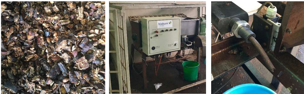
Abbildung 1: Testpelletierung (v.l.: Mischung Kaffeehülsen und Kakaoschoten; bioburn Pelletieranlage; Pellets beim Austritt aus der Düse)
