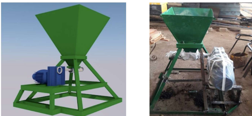
Abbildung 2: Grafische Darstellung der adaptierten Pelletiermaschine (links), Pelletiermaschine ab Werk (rechts)
