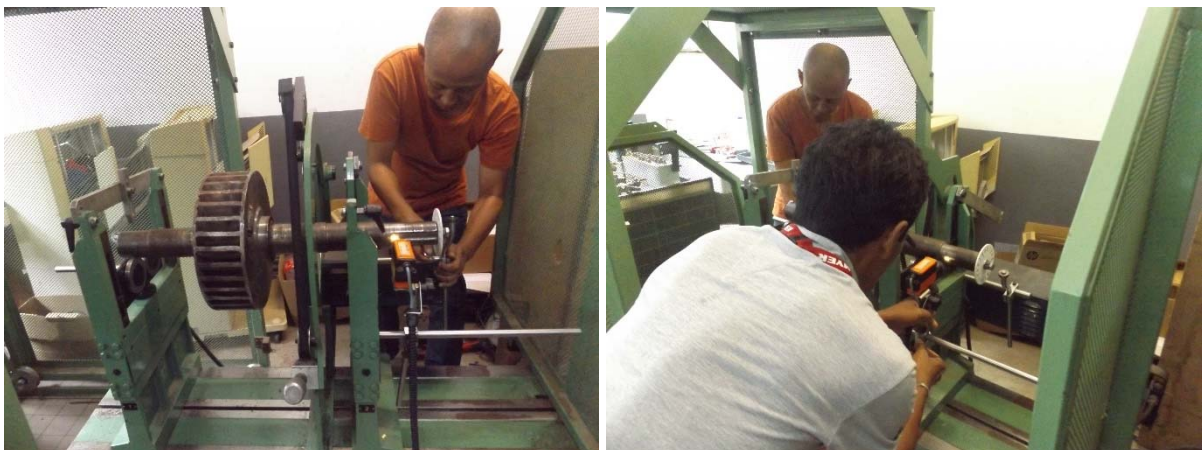
Figure 9: séance d'équilibrage pour corriger l'erreur sur la fabrication à l'IST-TANA
