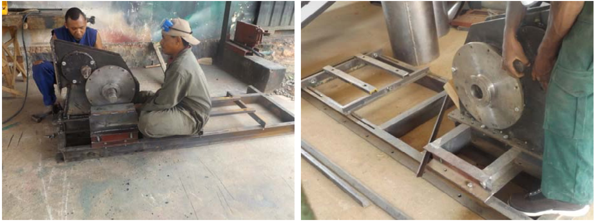
Figure 8: Fabrication de la turbine Banki chez Atelier Tsiky
