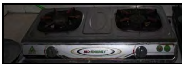
Cuisinière à biogaz
