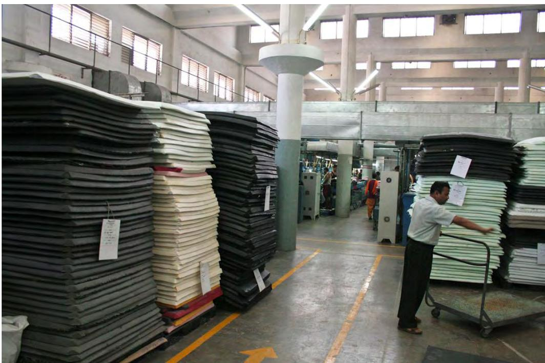
**Abbildung 12: Fertige EVA-Matten vor dem Zuschneiden und der Formgebung**
