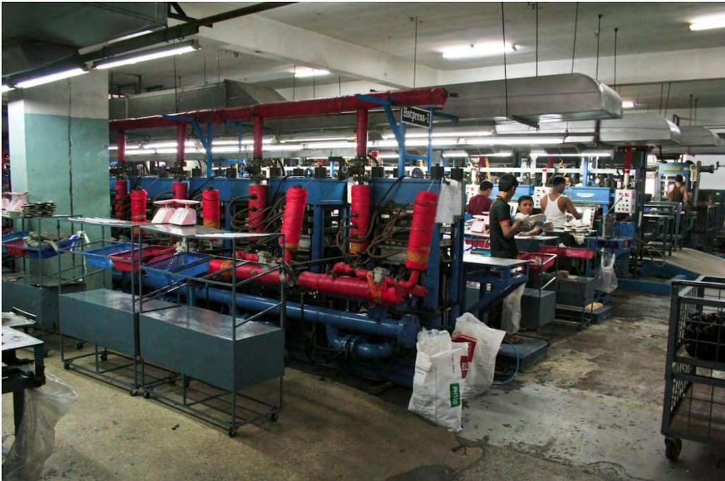
Abbildung 10: Hinterseite der Heisspress-Linien mit teils mangelnder Isolation
