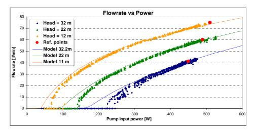
Fig 2.7. - Measurements of a Centrifugal Pump (Solarjack SCS14\_160)
