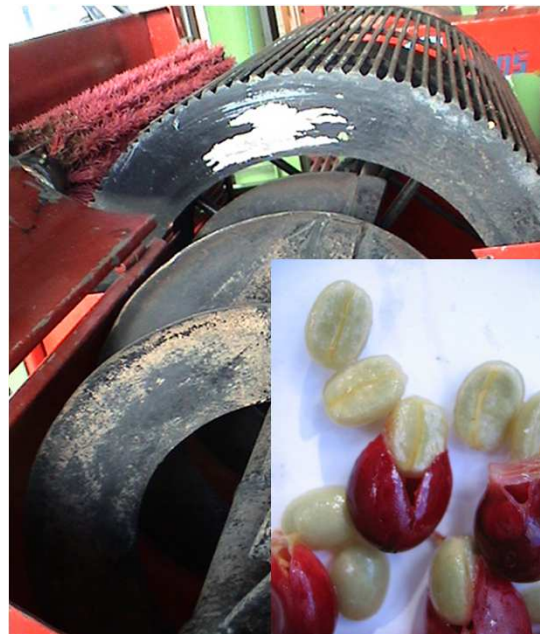
3. Pulping (pulp removal)
