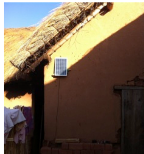
Petit panneau solaire privé permettant d'alimenter une radio
