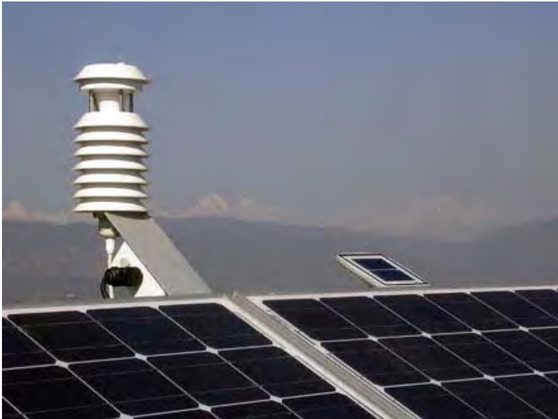
Figura 7: Sensore di temperatura ambiente ventilato ( T_a ) e cella di riferimento, tipo Sensol, per la misura di irraggiamento su piano inclinato ( G_i ).
