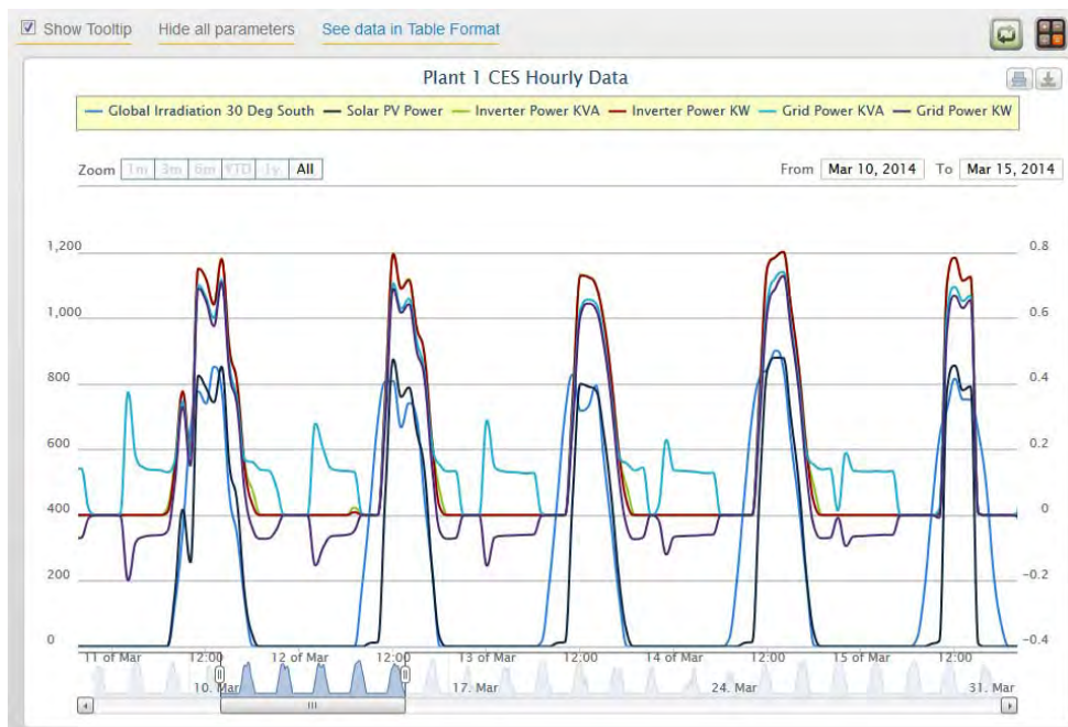
Figura 23: Esempio di visualizzazione dell'irraggiamento e della potenza dell'impianto P1 in marzo 2014, con consumi notturni prelevati dalla rete.
