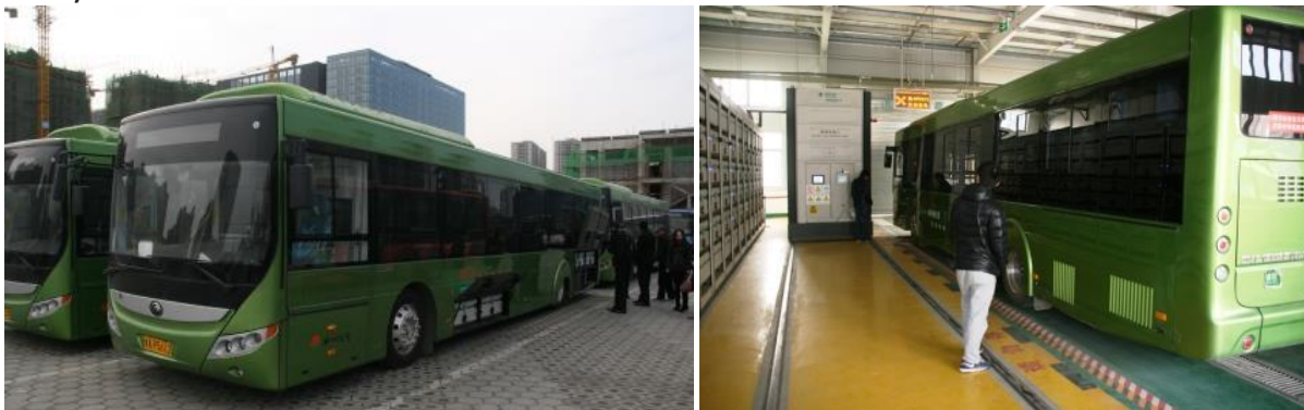
Foto 5: Yutong Bus Eléctrico de 12m y Sistema Robotizado de Intercambio Rápido de Baterías (Zhengzhou, China)
