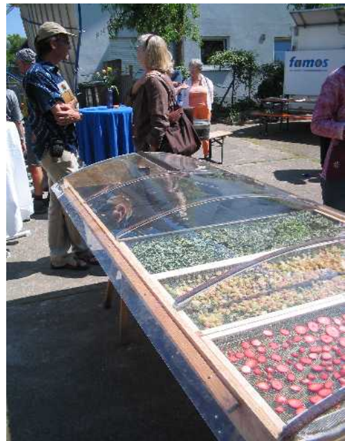
Kleiner Tunneltrockner in Deutschland.
