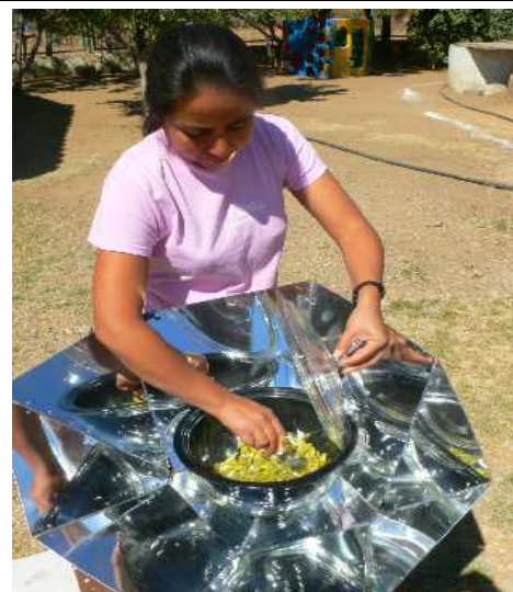
Der Hot-Pot Kocher aus Mexiko mit einem Reflektor aus Aluminium, Kochtopf und Windschutz aus Pyrex-Glas.
