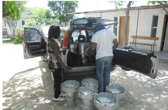
Für das letzte Los wurde nochmals eine Verbesserung des Design mit Inputs aus der Testphase und Feldversuchen durchgeführt. Zum ersten Mal kommt nun auch unbehandeltes Blech zum Einsatz, dort wo die Temperaturen hoch sind d.h. im Innenzylinder. Unverzinktes Blech ist jedoch in Haiti auf dem Markt schwieriger aufzutreiben als verzinktes.
