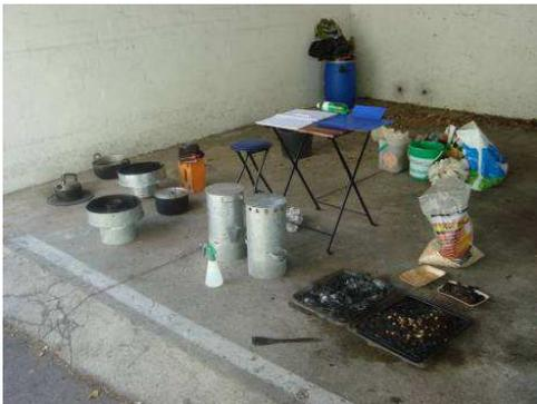
Wir haben diverse Tests in Basel durchgeführt und die bestehenden Réchaudsmodelle so modifiziert, dass der Pyrolyseprozess möglichst gut unterstützt wird. Dabei ist vor allem das Verhältnis der Grundgeometrie und der Primär- und Sekundäröffnung wichtig.
