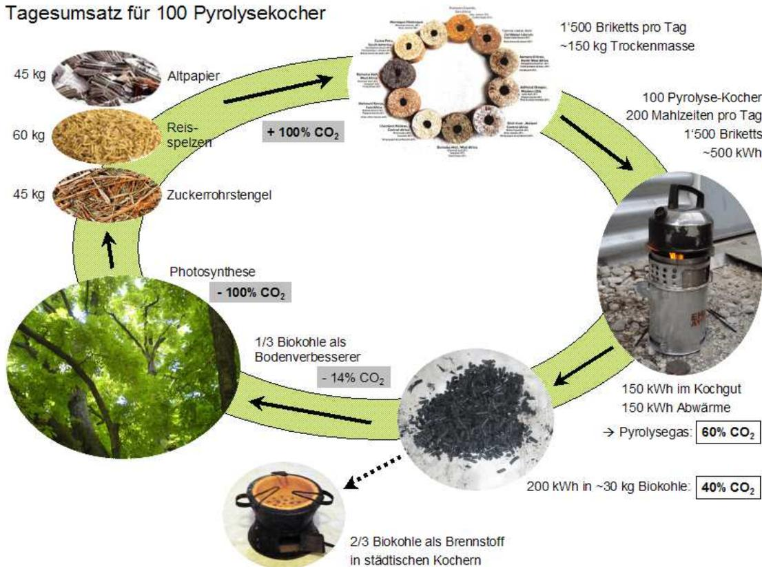
Abb 2.: Kohlenstoffkreislauf bei Einsatz von 100 Pyrolysekochern
