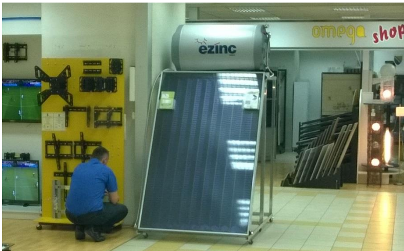
Abbildung 25: Funktionsmodell der solaren Thermosyphonanlage im Einkaufszentrum der Firma Omega.
