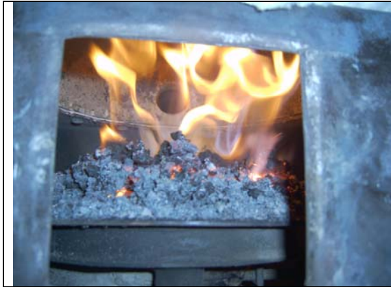
Abbildung 2 Versuche zum Schlackebildungsverhalten von Kaffeepulpe im Labor Klus
