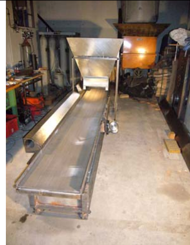
Abbildung 7: Pulpetrockner im Labor Klus kurz vor der Fertigstellung
