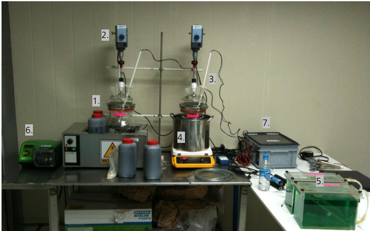
Abbildung 7: Die Pilotanlage (1.Reaktor, 2.Mischer, 3. Thermometer, 4. Wasserbad, 5. Gasmesser, 6. Pumpe, 7. Steuerung)
