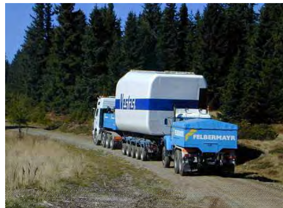
Doppelzugmaschinentransport der Gondel
