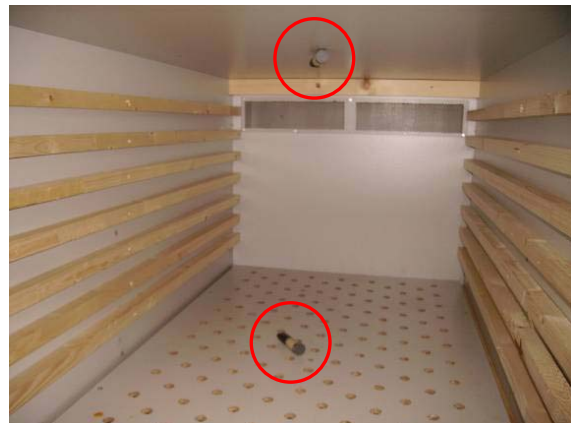
Abbildung 18: Kompakte Datenlogger im Trocknungsraum installiert.
