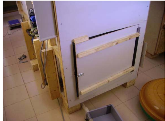
Abbildung 22: Die grosse Bypassklappe am hinteren Teil des Trockners, zur Luftdurchmischung.
