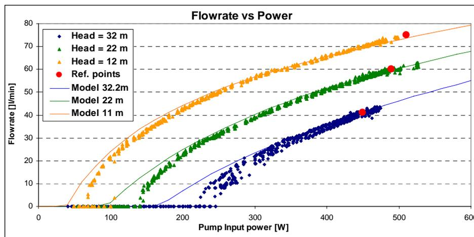
Fig 2.7. - Measurements of a Centrifugal Pump (Solarjack SCS14\_160)
